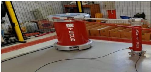
Gambar 1. Transformator yang diujikan
