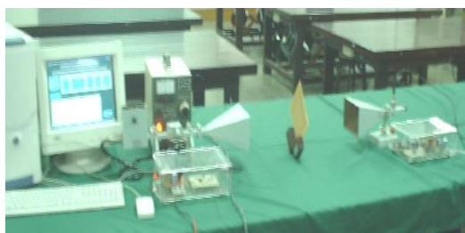
Gambar 11. Eksperimentasi pengiriman data melalui layar polarisator
