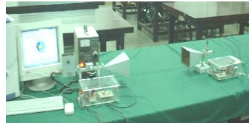
Gambar 8. Eksperimentasi pengiriman data secara langsung (line of sight)
